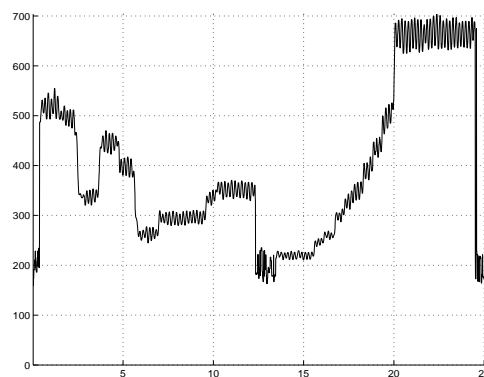
FIG. 14.2 – Trajet de f_0 pour la voix chantée. En abscisse: le temps en seconde; en ordonnée: la fréquence en Hz
