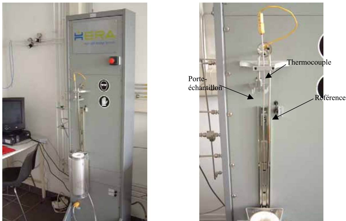
Figure 6.2 : Deux photographies de l'appareil de mesure d'adsorption d'Hydrogène
