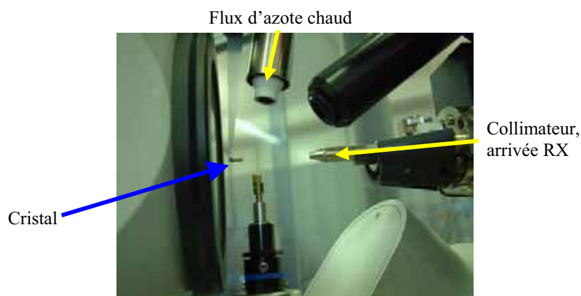
Figure 6.1 : Vue de l'expérience de diffraction sur monocristal en température
