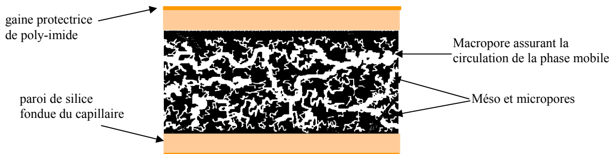
Figure 27 : Schéma de la structure d'un monolithe synthétisé in-situ dans un capillaire de silice fondue. Modèle proposé par Gusev et al. pour un copolymère de styrène et styrène divinyl benzène ancré sur des parois préalablement silanisées (d'après [122])
