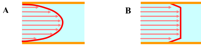
Figure 3 : Profil des écoulements A) Poiseuille B) électroosmotique
