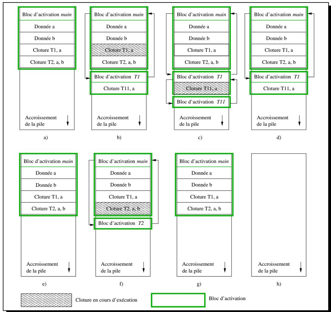
FIG. 4.1 – Evolution de la pile lors de l'exécution du programme de la figure 4.3
