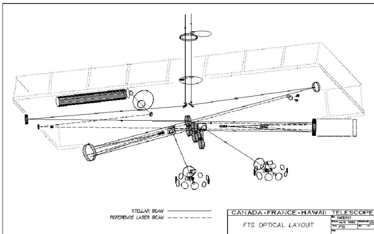
FIG. 5.4 – Plan du FTS du CFHT.
