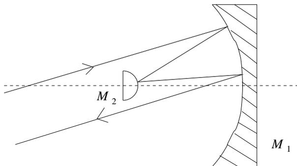
FIG. 5.2 – Œil-de-chat. Cette configuration optique permet à tout rayon entrant de ressortir parallèlement à lui-même, mais non confondu avec lui-même.
