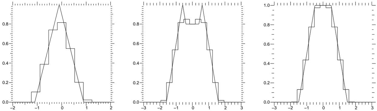
FIG. 6.1 – À gauche : représentation de l’image d’une source ponctuelle avec une PSF triangulaire (FWHM = 1), et le même profil échantillonné. Au milieu : deux sources de même intensité, séparées de  $1,2 \times \text{FWHM}$ . À droite : deux sources de même intensité séparées de  $1 \times \text{FWHM}$ .
