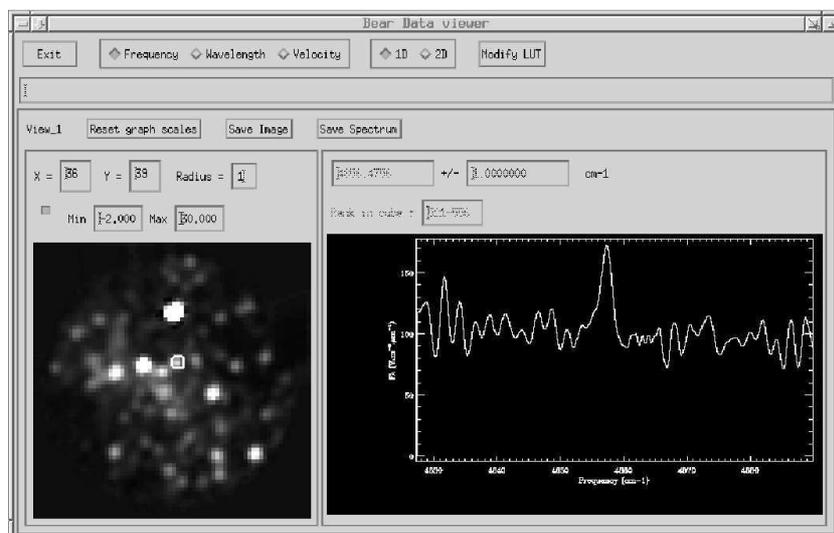
FIG. 5.6 – Exemple d’affichage de cubeview, le « *BEAR Data Viewer* ». L’image est la somme de 35 plans, centrés à peu près sur la raie que l’on voit dans le spectre. Ce spectre est la somme des pixels compris dans le cadre blanc, au centre de l’image. L’étoile sélectionnée est IRS 16NW.
