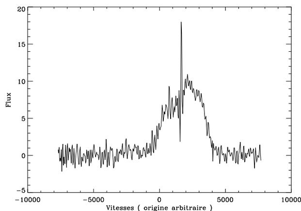
FIG. 5.8 – Spectre typique d’une étoile du champ avant calibration montrant la bande passante du filtre étroit centré à  $2,058 \mu\text{m}$ . Les deux raies fines et intenses sont des émissions atmosphériques de OH. Ce qui ressemble à une « raie » plus large à droite est en fait dû à ce qui passe au centre d’une bande tellurique de  $\text{CO}_2$  entre les branches P et R non résolues.
