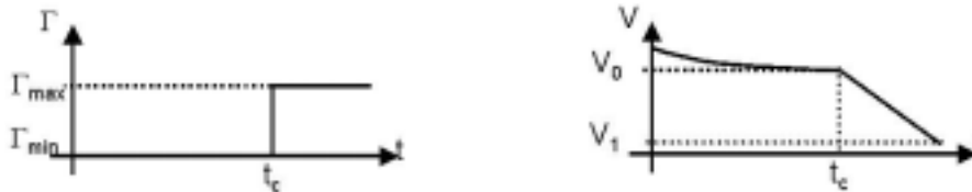
Figure 11 : Allure de la commande optimale de freinage et de la vitesse correspondante
