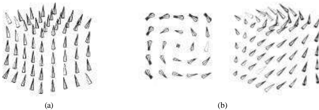
Fig. IV.1.2 : (a) Configuration des spins en pétale de fleur, (b) configuration avec un vortex vu de haut et de côté [Ferré 1995].
