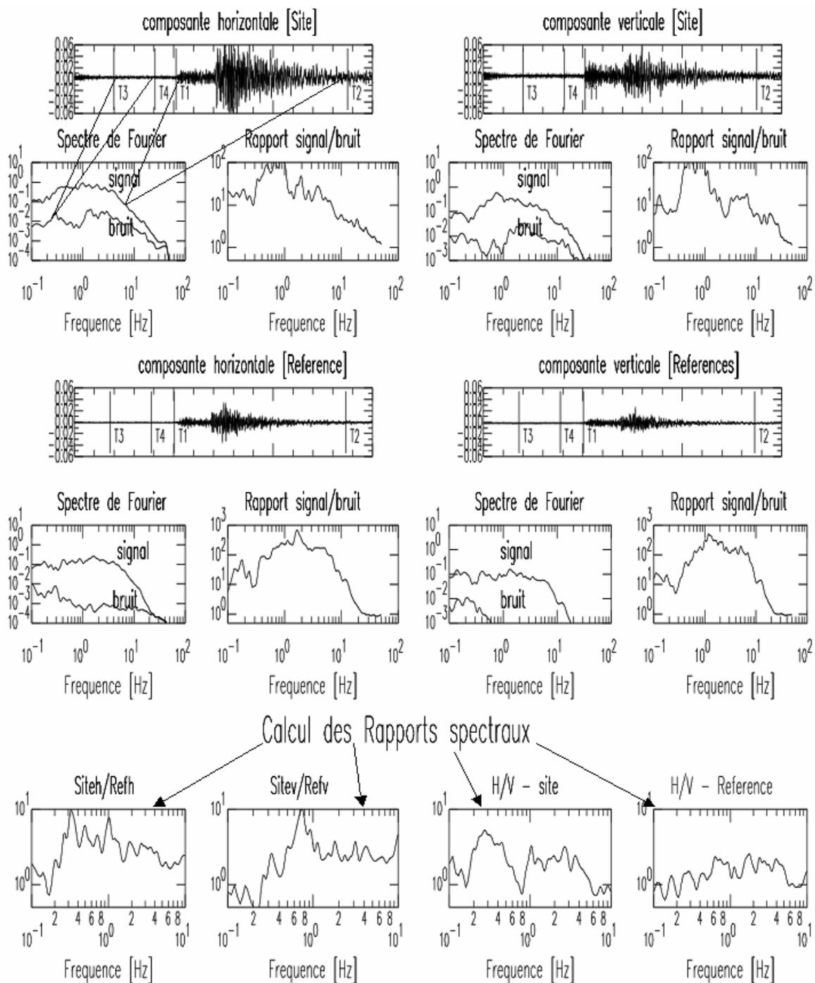
Figure 2.7 Schéma descriptif des méthodes rapport spectral site/référence et H/V (fonction récepteur), sur l'exemple du séisme du sud-ouest de Semnan et des stations MOF (site) et JAM (Référence)
