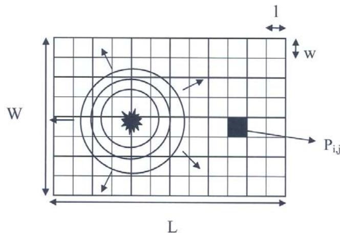
**Figure 5.3** Discrétisation de la faille. La rupture démarre au point de nucléation et le front de rupture s'étend circulairement. La sous-faille  $P_{i,j}$  casse à l'arrivée de ce front (d'après Causse 2004)
