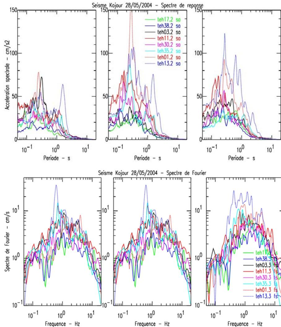
**Figure 5.16 Spectres de réponse (haut) et spectres de Fourier (bas) des accélérogrammes du séisme de Kojour, enregistrés par BHRC à Téhéran. Les composantes verticale, NS, et EW sont présentées respectivement de gauche à droite.**
