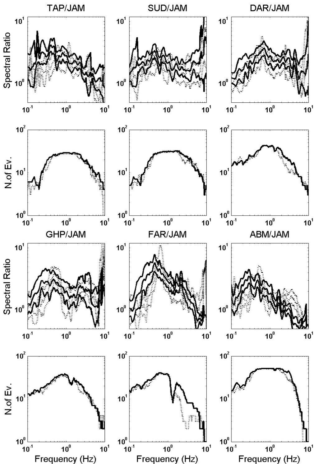
Figure 2.8 Rapports spectraux classiques (Site/JAM) ; pour chaque station, sont indiquées les moyennes et moyennes  $\pm$  écart-type pour les composantes horizontale (trait plein) et verticales (pointillés), ainsi que le nombre de données utilisées en fonction de la fréquence.
