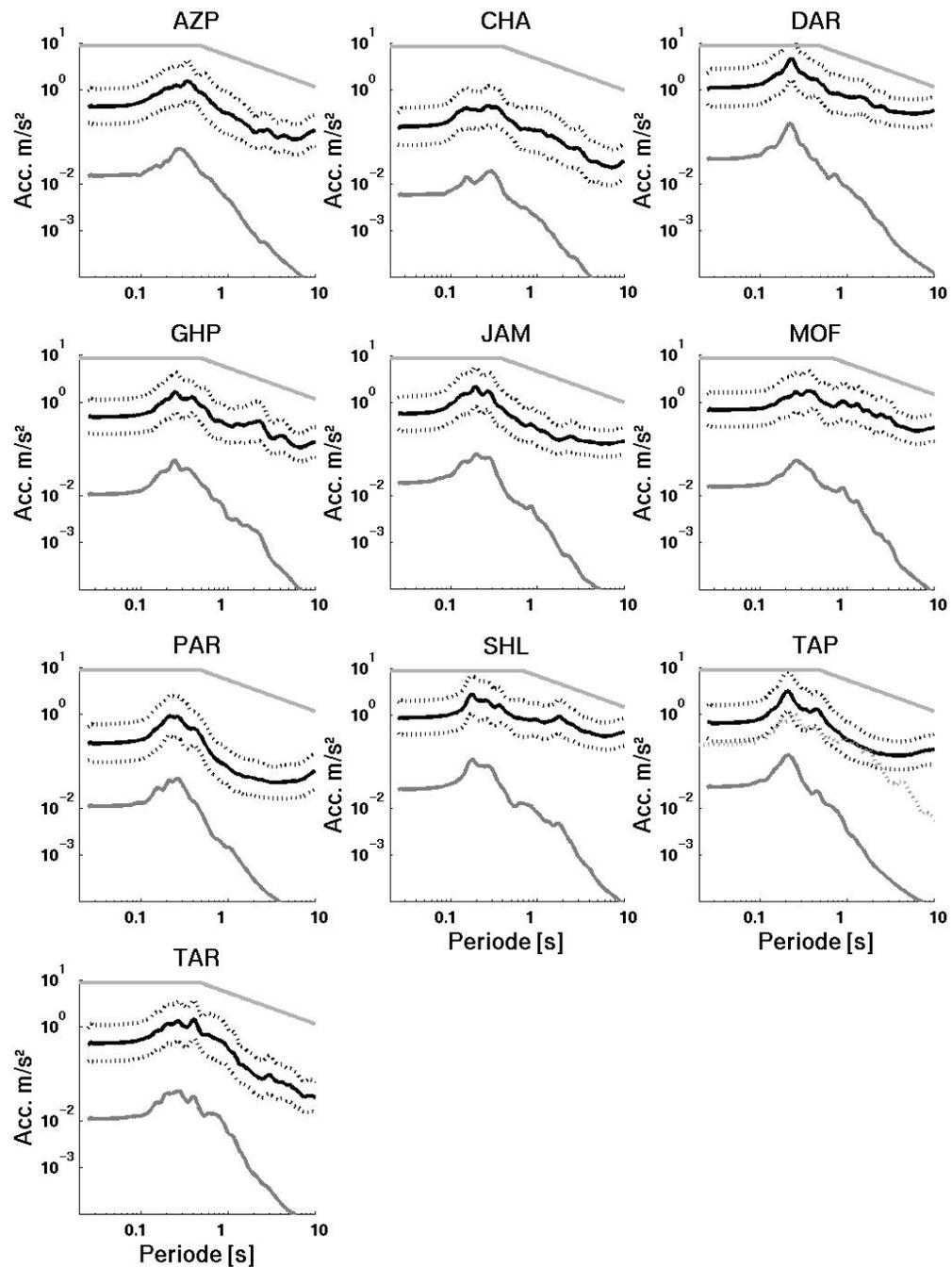
Figure 5.23 Spectres de réponse moyens (trait noir continu) et leurs écart types (pointillé noir) résultant de la simulation d'un séisme de  $M_w = 7.1$  sur la faille Nord Alborz à une distance épacentrale de 54 à 84 Km. Les spectres sont comparés à ceux des fonctions de Green empiriques utilisées (courbe gris foncé) et ceux proposés par la règle parasismique Iranienne (courbe gris clair).
