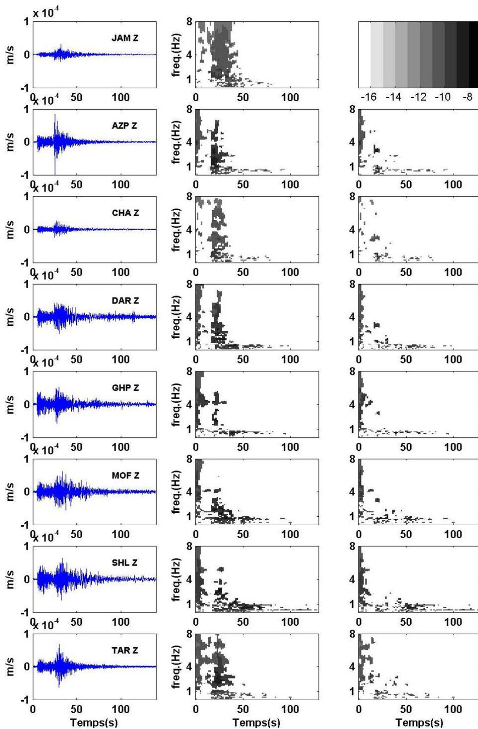
Figure 2.21 Analyse en sonogramme pour le séisme du sud-ouest de Semnan, composante verticale: signaux enregistrés aux différentes stations (colonne de gauche), sonogrammes renforcé  $D(f, t)$  (centre) et matrices différentielles  $E(f, t)$  (droite). L'échelle de grisé est indiquée en haut à droite.
