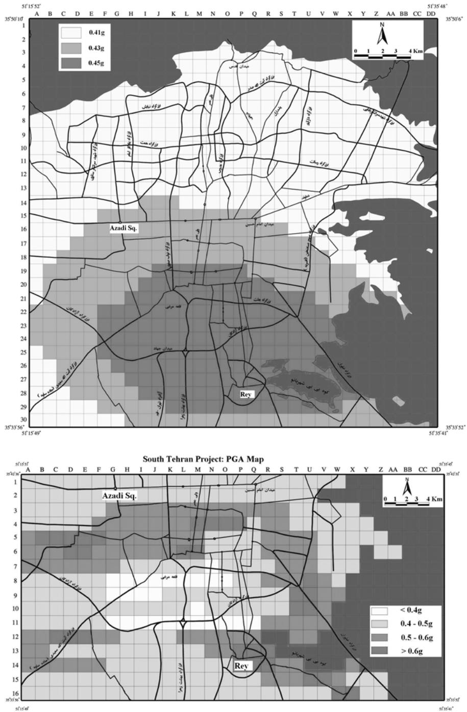
Figure 1.12 Accélération maximale au niveau de substratum rocheux (haut) et de la surface (bas).
