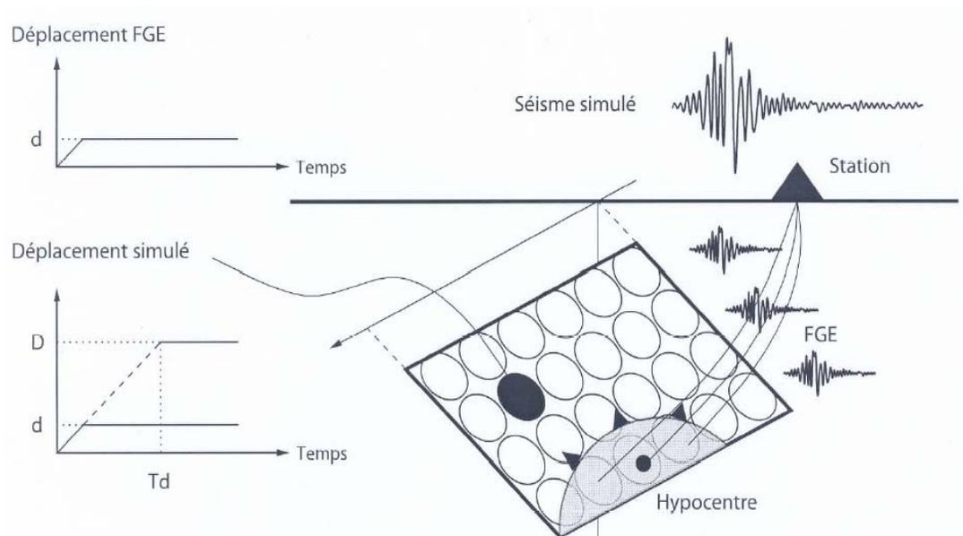
**Figure 5.1 Différentes contributions aux décalages temporels entre les petits séismes: propagation de la rupture, temps de montée ( $T_d$ ) de la dislocation et propagation des ondes entre la source et le site (d'après Bour [1993])**
