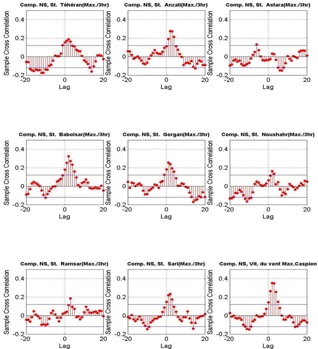
**Figure 3.12 "Cross corrélation ente l'amplitude spectrale (max. par tranche de 3hr); composante NS et la vitesse du vent. Pour le dernier cadre, c'est la valeur enveloppe de la vitesse sur la côte Caspienne**
