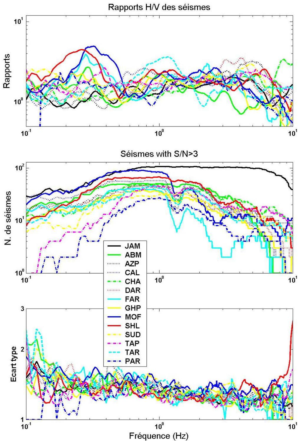
Figure 2.10 Rapports H/V obtenus à partir des enregistrements de séismes: le cadre du haut présente les valeurs moyennes, celui du milieu le nombre d'événements utilisés avec le critère  $S/N > 3$ , celui du bas les écart-types (exprimés en termes de facteur d'incertitude).
