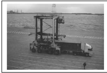
Figure 2. L'intermodalité : chargement d'un conteneur sur un camion.
