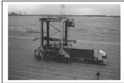
Figure 2. L'intermodalité : chargement d'un conteneur sur un camion.
