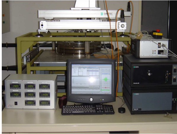
FIG. 2.8 – Acquisition des données de pression (à gauche) et de vitesse (à droite).
