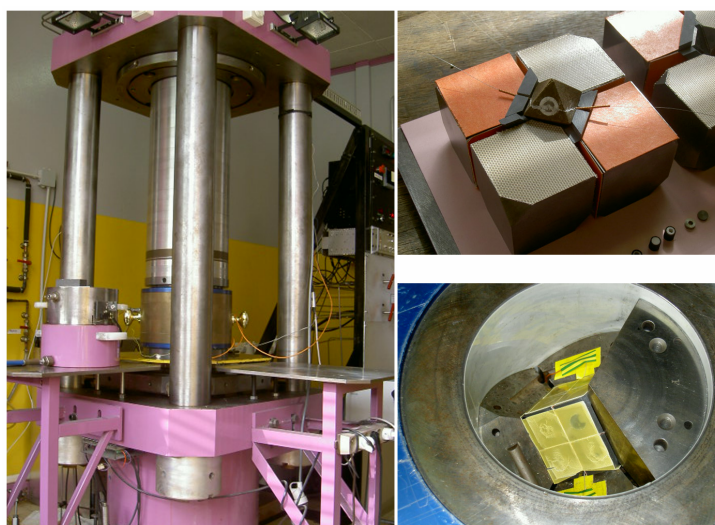
FIG. 3.21 – La presse 1000 tonnes multi-enclumes. A gauche vue générale de la presse. En haut à droite vue du montage octaédrique. On distingue les 4 enclumes inférieures en carbure de tungstène et leur sommet tronqué. En bas à droite montage en place dans la presse.
