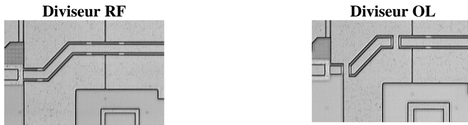
Figure 91: Ponts des guides coplanaires situés de part et d'autre de l'inductance de couplage sur le second étage du diviseur de puissance pour la voie RF, puis OL.
