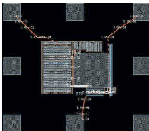
Figure 36 Vue du layout d'un circuit intégré
