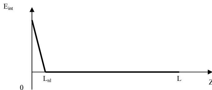
Figure 8: Profil du champ électrique interne pendant le traitement de poling thermique.
