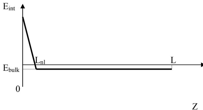
Figure 9: Profil du champ électrique interne après le traitement de poling thermique.
