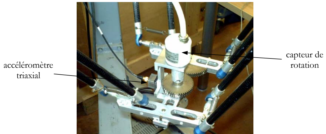
Figure 2.4. Capteurs additionnels ajoutés à la nacelle
