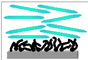
Figure 53 : Ancre planaire du cristal liquide déposé sur plaque de fer recouverte d'une monocouche de di-N-octylamine à l'état liquide
