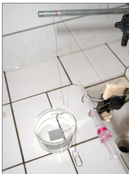
Figure 50 : Photographie du montage de dépôt de monocouche sur plaque
