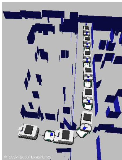
FIG. 4.10 – La trajectoire finale déformée telle que le robot l'a exécutée.
