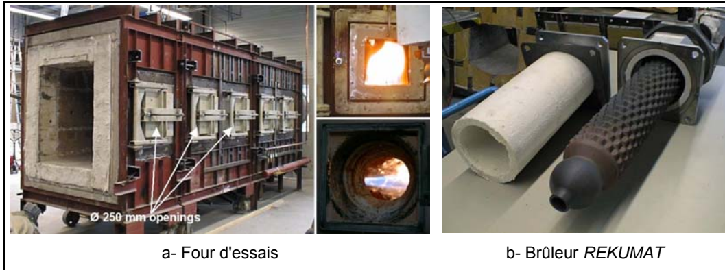
figure 1-38 : Installation d'essais du GWI (Kösters - 2005)
