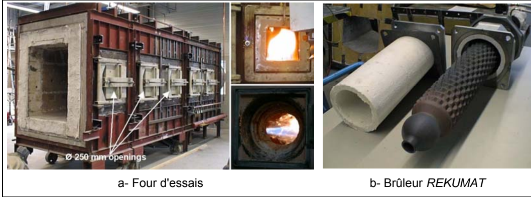
figure 1-38 : Installation d'essais du GWI (Kösters - 2005)
