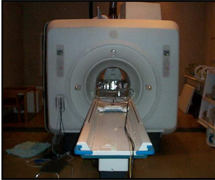
FIG. 3.1 – Photo de l'appareil clinique d'imagerie médicale (SIGNA, General Electric, Milwaukee, USA) implanté à l'hôpital du Kremlin-Bicêtre de 1985 à 2004. L'imageur clinique est basé sur un aimant horizontal supraconducteur qui produit un champ magnétique homogène de 1.5 Tesla.
