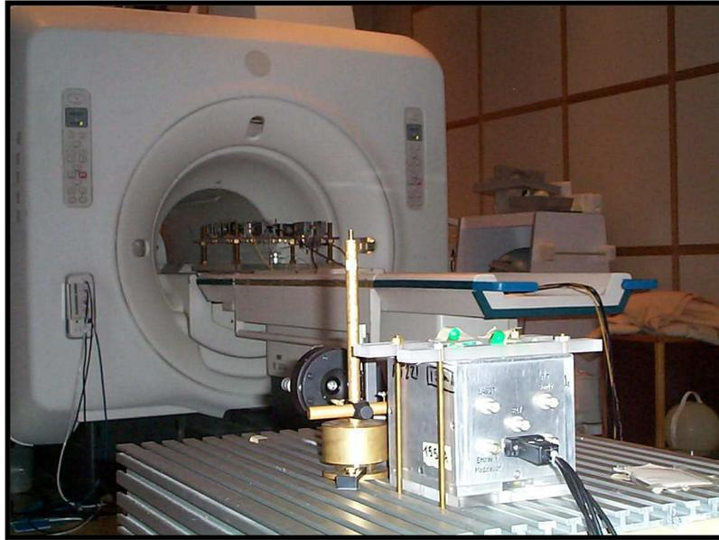
FIG. 3.7 – Vue d’ensemble. Les lasers (dont la diode sonde au premier plan), les appareils électroniques et le système d’acquisition informatique restent dans une région de faible champ magnétique.
