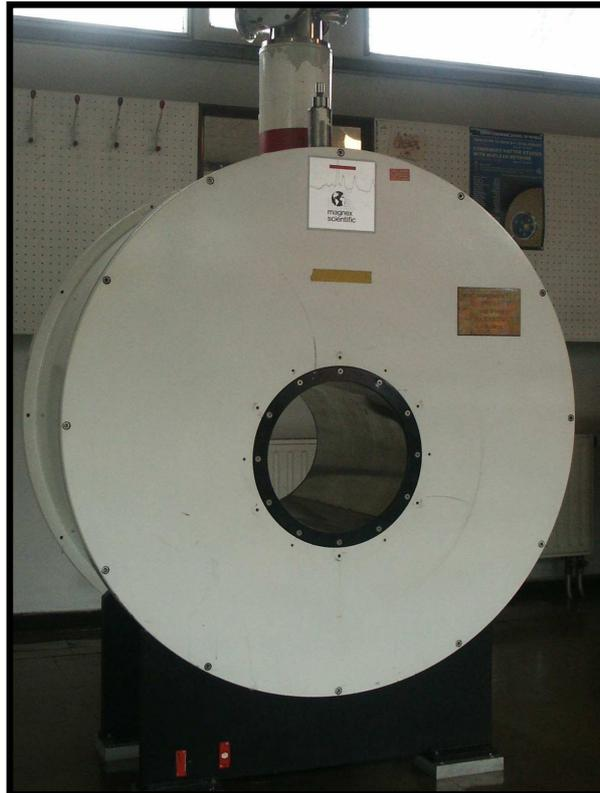
FIG. 7.8 – Photo de l'aimant supraconducteur implanté à l'Université Jagellone à Cracovie. L'aimant produit un champ magnétique  $\mathbf{B}$  homogène pouvant être varié de quelques mTesla à 2 Tesla. Le tunnel de l'aimant a un diamètre de 0.3 m et une profondeur de 0.5 m.
