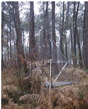
FIG. 4.1 – Photographie du trièdre installé dans la parcelle la plus âgée
