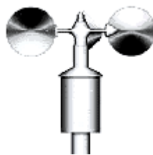
Figure 2-21 - Anémomètre à trois coupelles à 120°
