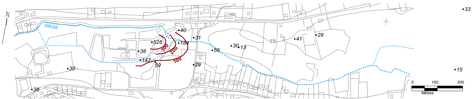
FIG. 63 – Anhydride carbonique dans la nappe de la craie : valeurs moyennes observées pendant l'année 2001 en mg/l (bruit de fond : 30 mg/l)
