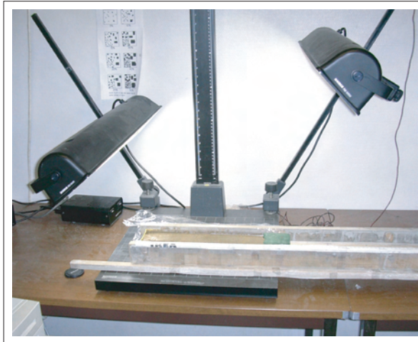
Photo II.5 : Le banc de numérisation utilisé pour le traitement des carottes en images (cliché A.S. Perroux).
