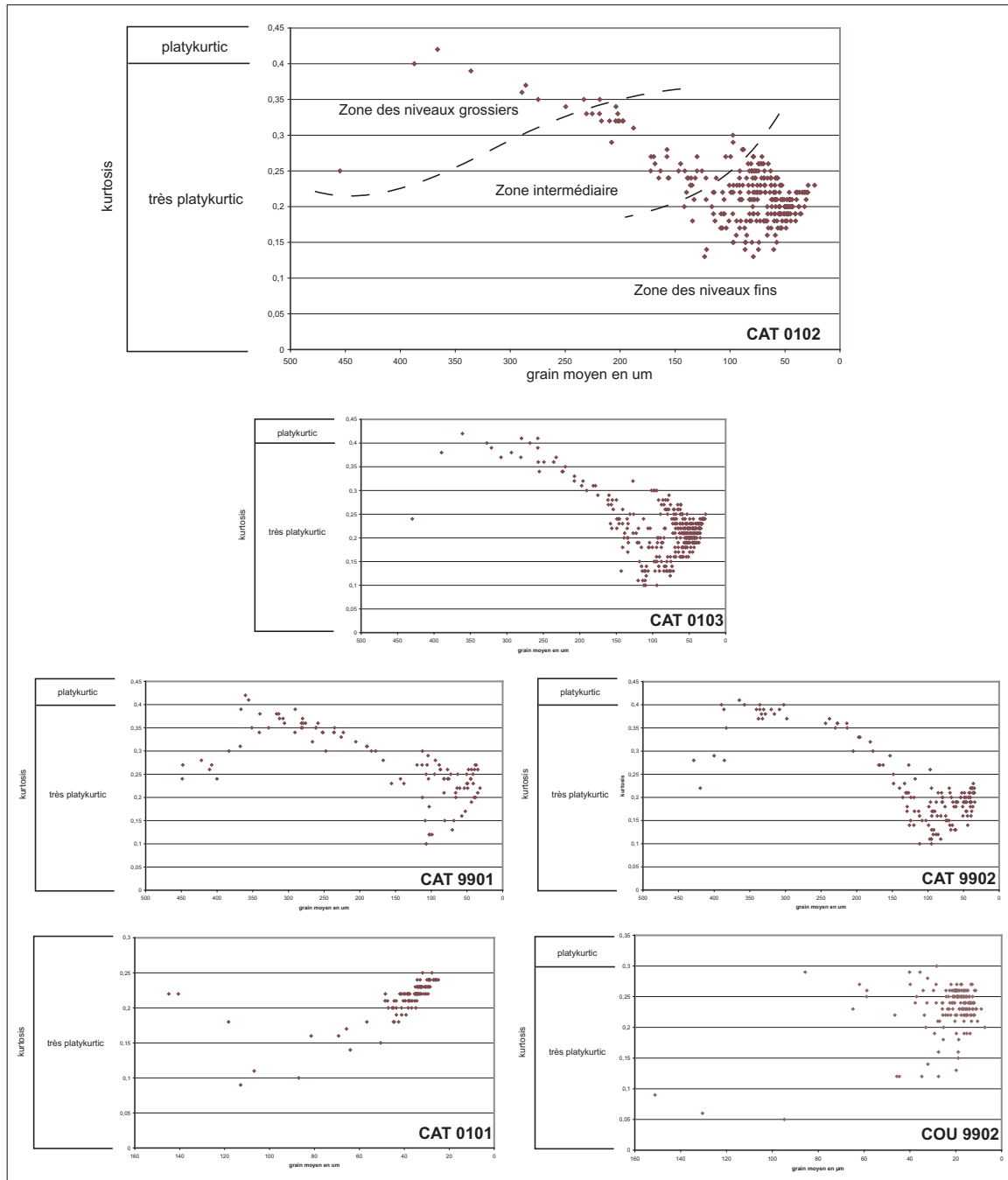
Figure III.30 : Le croisement du kurtosis et du grain moyen comme critère de définition de la qualité d'une distribution granulométrique dans les six prélèvements.
