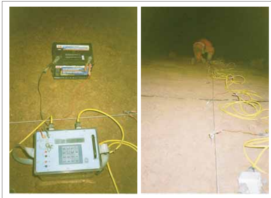
Photo II.9 : Le dispositif nécessaire pour la méthode de prospection géophysique par tomographie électrique (cliché A.S. Perroux).
