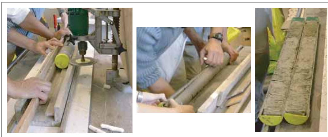
Photo II.3 : Ouverture d'une carotte au laboratoire (cliché A.S. Perroux).
