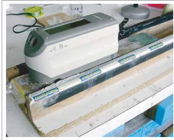
Photo II.7 : Le spectrophotomètre Minolta CM 2600 d™ (cliché A.S. Perroux).
