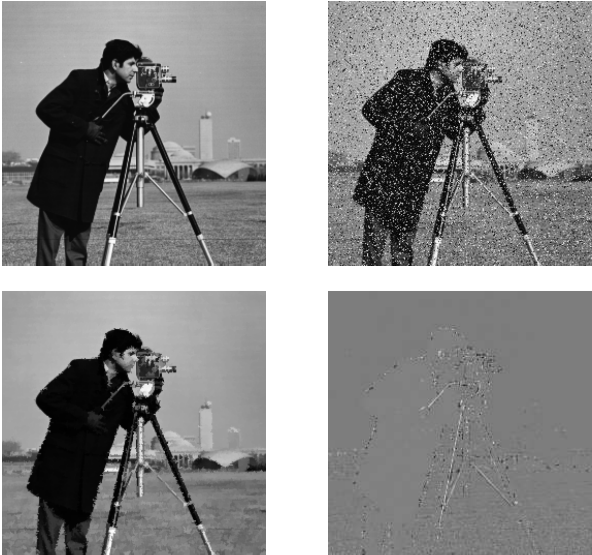
FIG. 5.6 – Première ligne : sont représentées, à gauche, l'image originale u du caméraman (de taille 256 \times 256 ) et à droite, l'image dégradée v par un bruit impulsionnel d'intensité p = 0.2 . Deuxième ligne : à gauche, l'image débruitée \tilde{v} produite par le filtre T avec un seuil \varepsilon = 10^{-3} et à droite, la différence u - \tilde{v} . Nous constatons que la majorité du bruit a été supprimée excepté sur les bords des objets.
