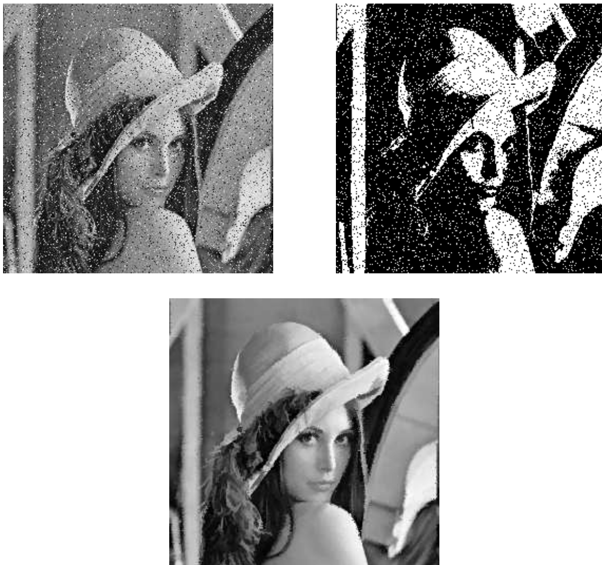
FIG. 5.5 – Première ligne : à gauche, est représentée l'image dégradée v (de taille 256 \times 256 ) obtenue à partir de Lena par un bruit impulsionnel d'intensité p = 0.15 et à droite, l'image seuillée v_{150} . Tous les pixels dont le niveau de gris (dans v ) est supérieur à 150 sont représentés par des pixels blancs dans v_{150} . Deuxième ligne : l'image débruitée \tilde{v} produite par le filtre T avec un seuil \varepsilon = 10^{-3} .
