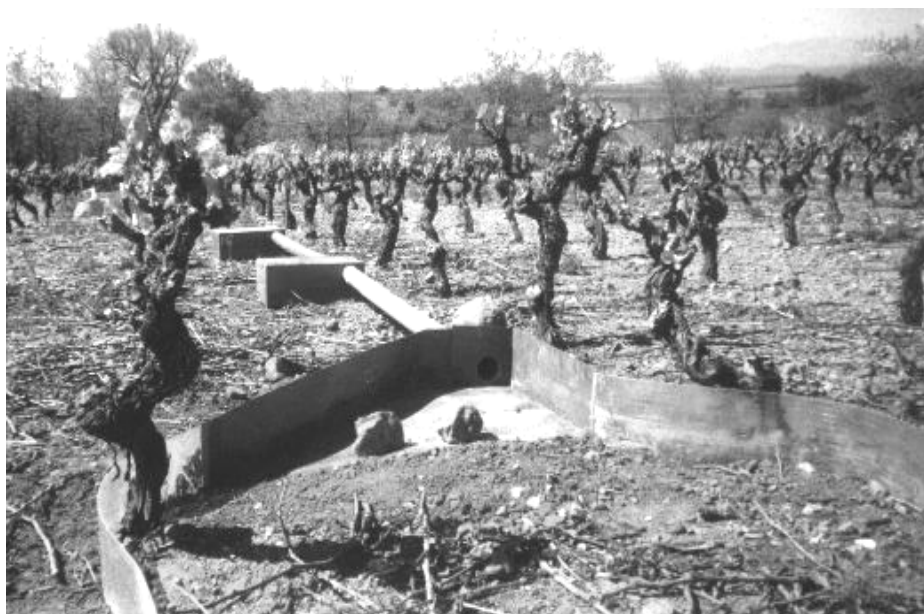
Figure 12 : Système de prélèvement ponctuel des eaux de ruissellement à la surface de l'inter-rang d'une parcelle viticole (parcelle sur sol acide). Photo A. Devez et R. Gilbin.
