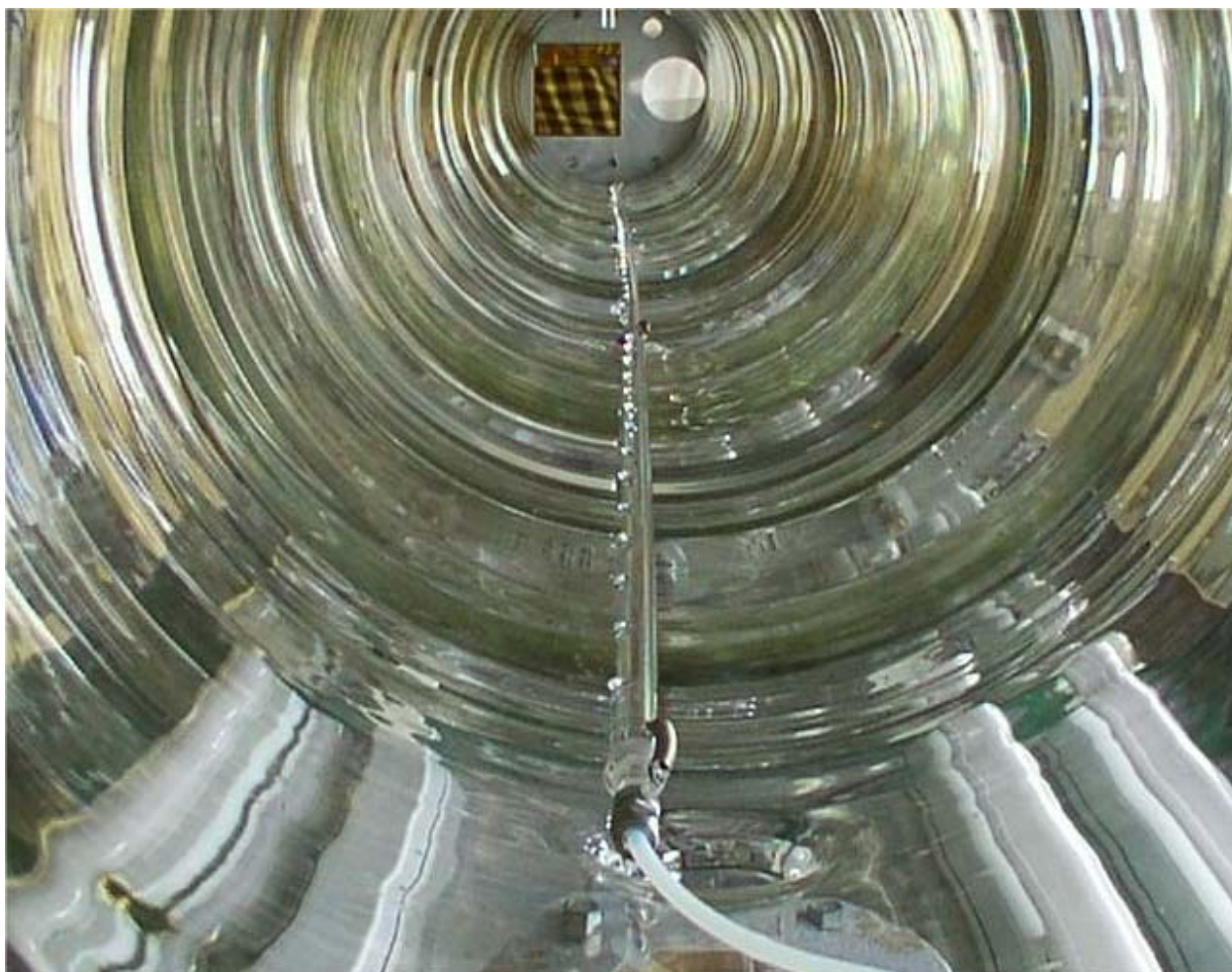
Figure 10 : Canne d'introduction des réactifs à l'intérieur de la chambre de simulation du LISA (vue longitudinale).
