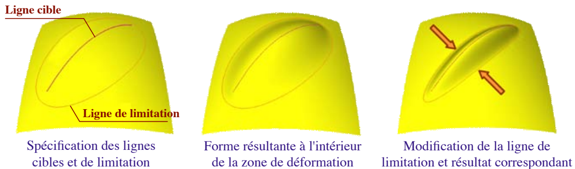
Figure 4.11. DEFSURF : Utilisation de lignes cibles et ligne de limitation [Pernot and al., 2003]
