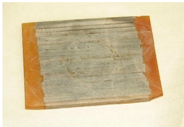
III.45c : Echantillon de 4mm usiné dans le bloc
