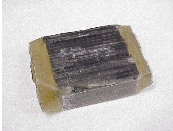
III.45b: Bloc obtenu après collage sous presse
