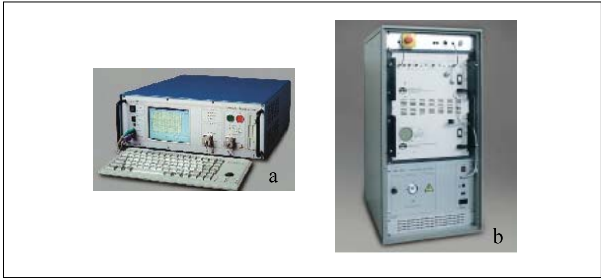
Figure III.10 : Photographie du système Programma ; a : Partie basse tension IDA 200 et b : Partie haute tension IDA HVU
