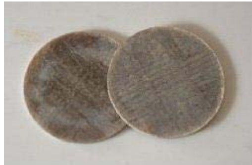
Figure II.5: Les échantillons usinés pour les mesures de cinétique de reprise en eau
