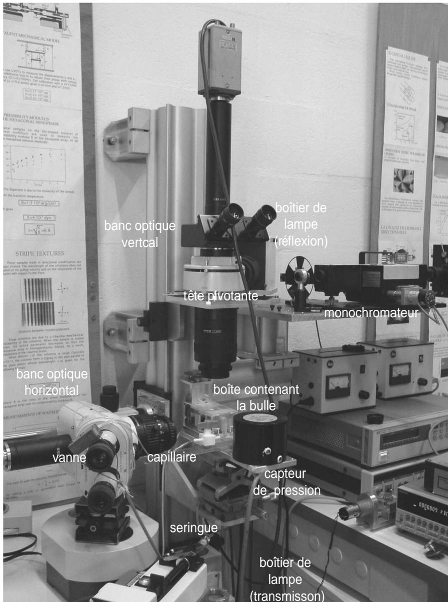
FIG. 7.3 – Photo du dispositif expérimental.
