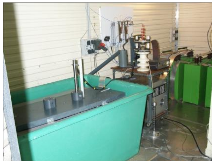
Figure II-2 : Démonstrateur à l'intérieur de sa cage de Faraday
