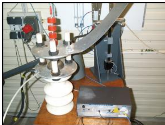
Figure II-7 : Commutateur associé à son système de déclenchement
