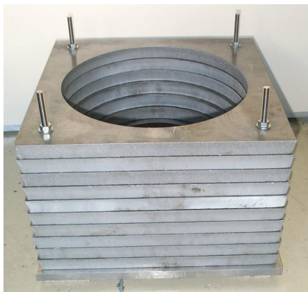
Figure II-9 : Photographie de l'enceinte en aluminium contenant les électrodes et les produits à traiter
