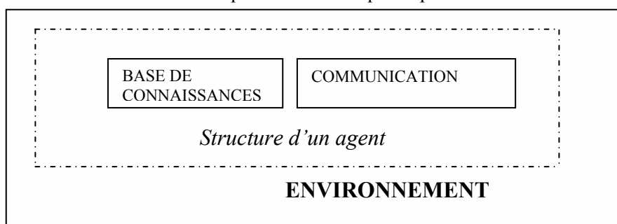
Figure 34: Structure d'un agent réactif dans le modèle MANGA.
