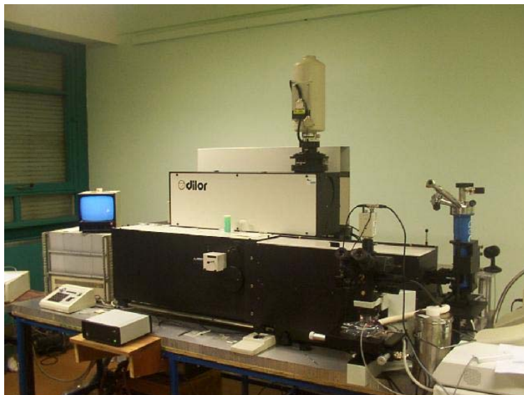
FIG. 2.18 – Spectromètre Dilor XY du laboratoire LDSMM.
