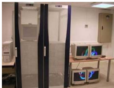
(b) Visualisation parallèle avec une grappe de PC contrôlant un rendu sur quatre écrans.
