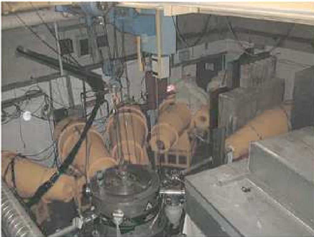
Figure 5.5: Vue générale du dispositif expérimental. Au centre, on distingue la chambre à vide et la ligne de faisceau. Au fond de la photographie, on peut voir, de gauche à droite, quatre détecteurs neutron et la cage de Faraday protégés par des blindages en paraffine borée en forme de canon.
