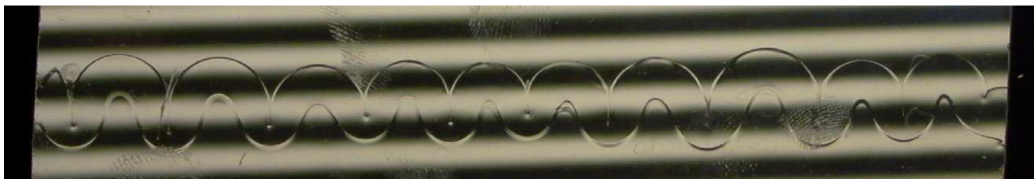
FIG. 1.6 – Photo de face des deux couches de gel à l'équilibre. La grille de bandes noires et blanches placée derrière la cellule permet d'observer les interfaces en utilisant la diffusion de la lumière. Rappelons que les deux gels ont pratiquement le même indice que l'eau.
