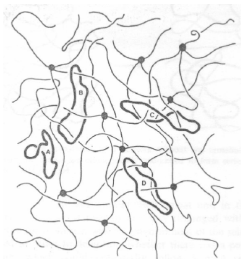
Figure.I.16. Schéma de piégeage des oligomères cycliques pendant la formation du réseau [Mark89] .
