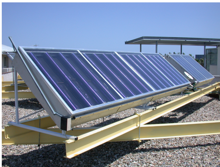
Figure 74 : Capteurs solaires secondaire (à gauche) et primaire (à droite) séparés par le pyranomètre.
