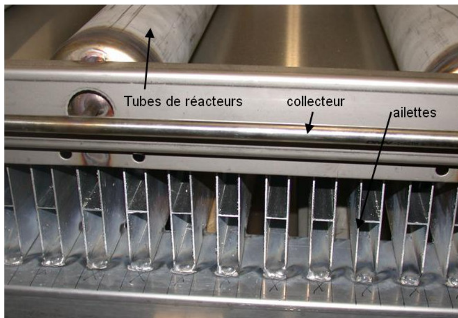
Figure 72 : Configuration des ailettes installées sur le capteur 2.
