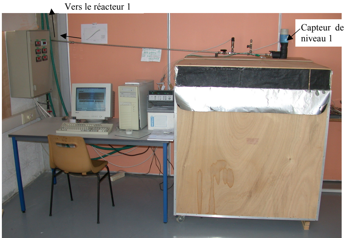
Chambre froide et système d'acquisition
