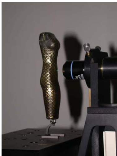
Figure 53 : Analyse de la patine d'une statuette égyptienne par micro spectrométrie RAMAN
