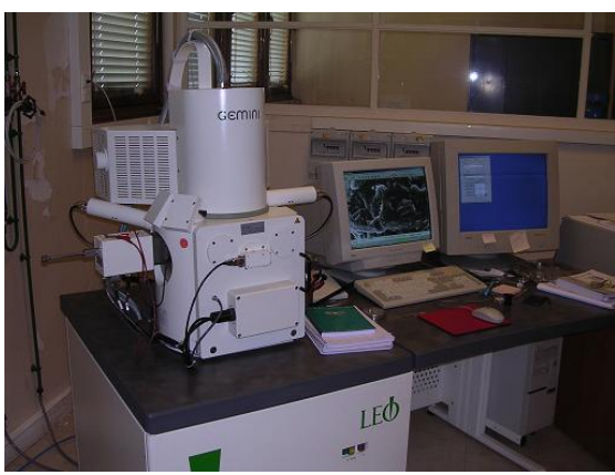
Figure 1 : Schéma de principe du MEB et photographie du MEB KARL ZEISS Gemini 1525 du SRMP – CEA Saclay
