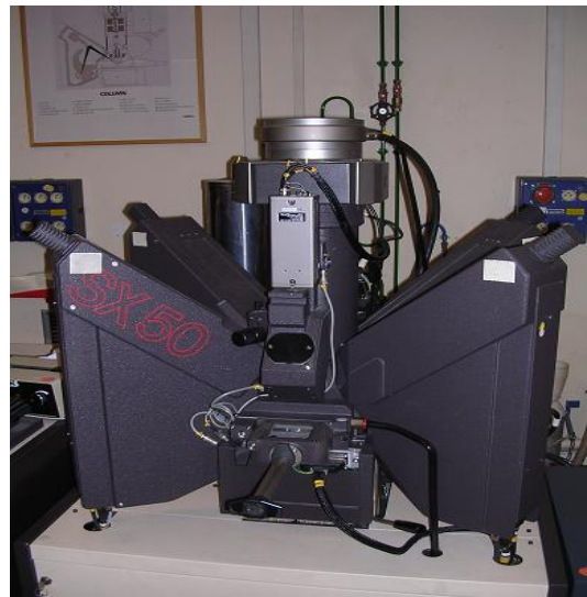
Figure 3 : Schéma de principe et photographie de la microsonde électronique CAMECA SX 50 du SRMP du CEA de Saclay
