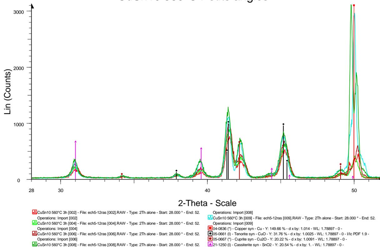
**Diffractogrammes obtenus sur du CuSn5 oxydé à 560°C pendant 3h à différents angles d'incidence :
