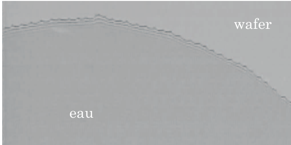
FIG. 4.29: Visualisation d'une perturbation sur toute la ligne de contact d'une goutte d'eau déposé sur un wafer piranisé. Cette perturbation est présente sur toute la ligne de contact en début de rétraction.
