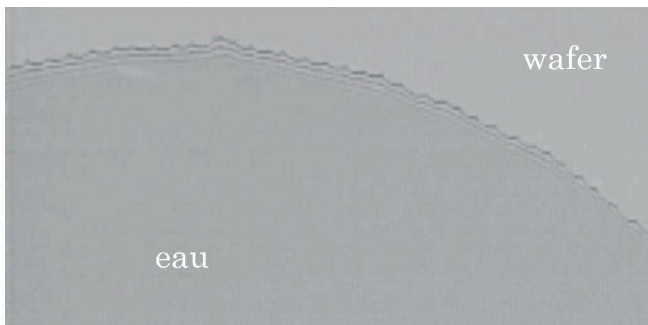
FIG. 4.29: Visualisation d'une perturbation sur toute la ligne de contact d'une goutte d'eau déposée sur un wafer piranhisé. Cette perturbation est présente sur toute la ligne de contact en début de rétraction.
