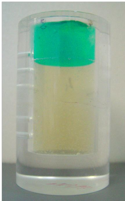
**Figure 1. Cellule de diffusion gel-gel**
