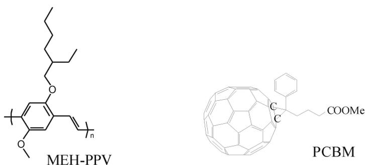
FIG. 4.1 – Structure chimique des molécules MEH-PPV et PCBM.
